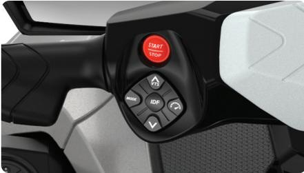
**iDF – Intelligentes selbstreinigendes Pumpensystem**
