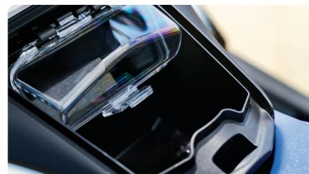
**Vorderes Staufach und wasserdichtes Telefonfach**
